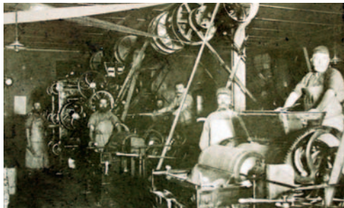
Abb. 9 Mit Dampf angetriebene Melangeure und Walzmaschinen um 1900
